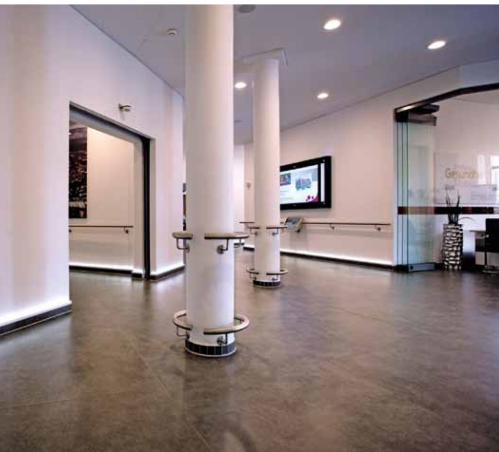
Visuelle Barrierefreiheit im Eingangsbereich: Kräftiger Kontrast zwischen Boden und Wand. Eine tiefe Lichtleiste sorgt für eine klare Unterscheidung zwischen Wand und Tür, auffällige Bilder und Wandelemente bieten Orientierung.
